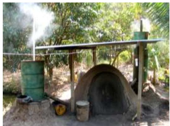
ภาพที่ 12 เตาดินเหนียวก่อ (Mud Beehive Kiln) สำหรับผลิตน้ำส้มควันไม้
