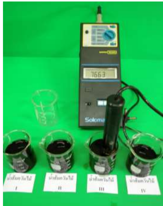
ภาพผนวกที่ 22 การวัดค่าการแลกเปลี่ยนประจุ โดยใช้เครื่องวัดการนำไฟฟ้า
