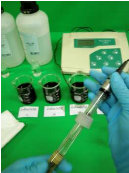
ภาพผนวกที่ 19 การวัดค่าความเป็นกรดโดยใช้ เครื่องวัดความเป็นกรดเป็นค่า
