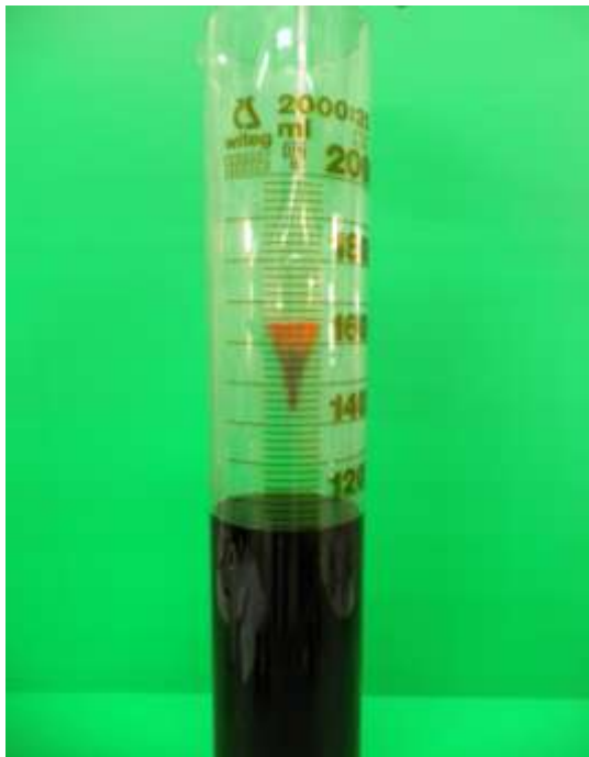
ภาพผนวกที่ 21 การวัดค่าความถ่วงจำเพาะโดย ใช้ไฮโดรมิเตอร์
