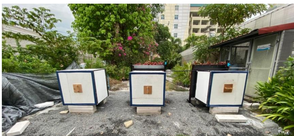
ขั้นตอนที่ 1 นำเครื่องเก็บอุณภูมิมาตั้งค่า วันที่ และเวลา ที่จะเริ่มทำการเก็บอุณหภูมิ
