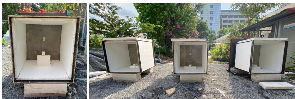
ภาพที่ 3.10 ติดตั้งเครื่องมือวัดอุณหภูมิภายในกล่องทดลอง
