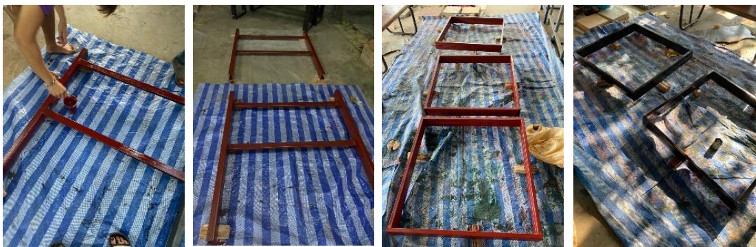
ขั้นตอนที่ 3 ทาสีกันสนิม ทิ้งไว้ให้แห้ง 1 ชั่วโมง ทาสีดำ 2 รอบ ทิ้งระยะห่างไว้ 2 ชั่วโมง และทาสีน้ำมันเพื่อเคลือบเงา
