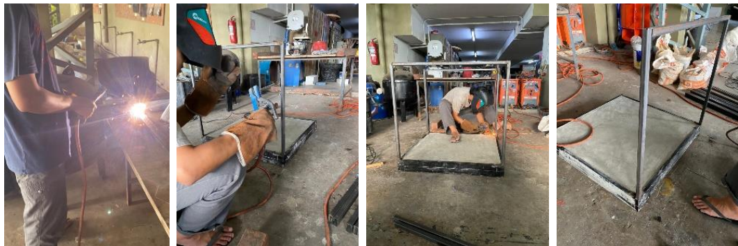
ขั้นตอนที่ 2 เชื่อมเหล็กกล่องติดกันเพื่อทำโครงสร้างของกล่องทดลอง
