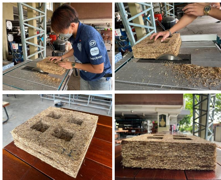
ภาพที่ 6 นำแผ่นที่ตากเสร็จเรียบร้อยแล้ว มาตัดขอบเพื่อความสวยงาม
