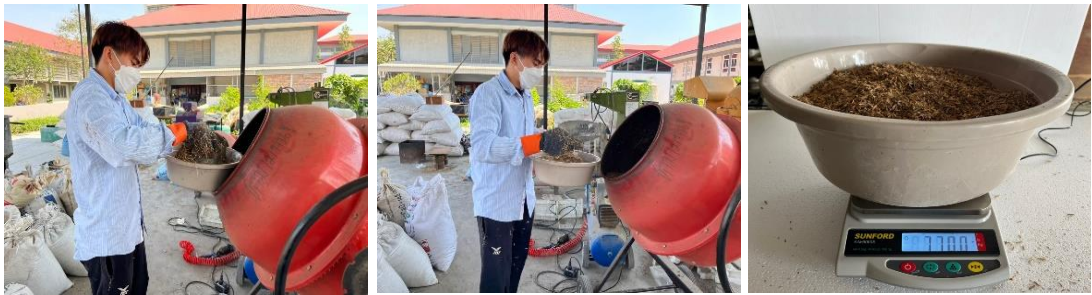
ภาพที่ 8 นำส่วนผสมที่คลุกเคล้ากันเสร็จเรียบร้อยแล้ว มาชั่งน้ำหนักเพื่อที่จะทำการอัดแผ่นในขั้นตอนต่อไป
