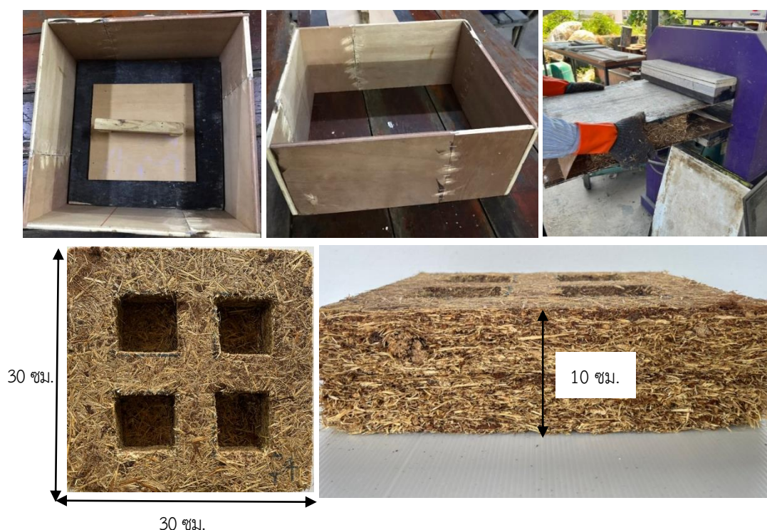
ภาพที่ 3.8 การขึ้นรูปแผ่นปลูกพืชสวนแนวตั้ง
