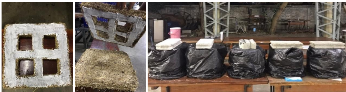
ภาพที่ 5 นำแผ่นที่ตัดช่องมาตาก และนำมาประกบกับอีกแผ่น ทิ้งไว้ 1 วัน
