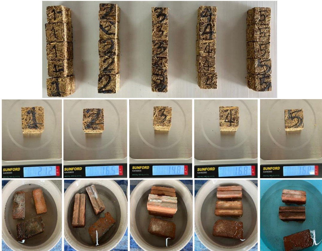
ภาพที่ 3.9 การทดสอบหาการดูดซึมน้ำ
