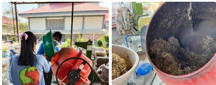
ภาพที่ 6 นำส่วนผสมที่ชั่งมาใส่ในโม้ เพื่อคลุกเคล้าให้ส่วนผสมเข้ากันซึ่งจะทำครั้งละสูตร
