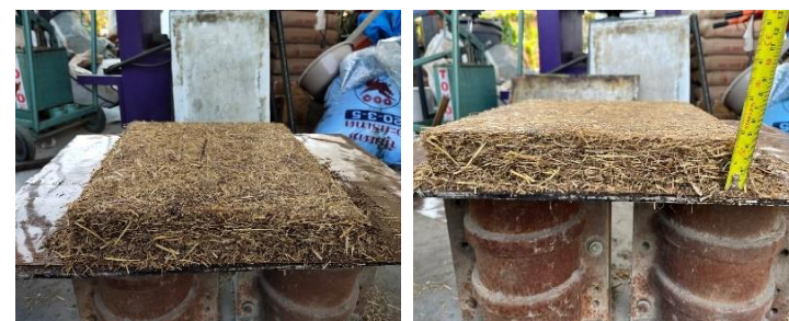
ภาพที่ 3 หลังนำออกจากเครื่องอัดร้อน แผ่นปลูกพืชจะมีขนาด 4 เซนติเมตร จะทำทั้งหมดสูตรละ 10 แผ่น
