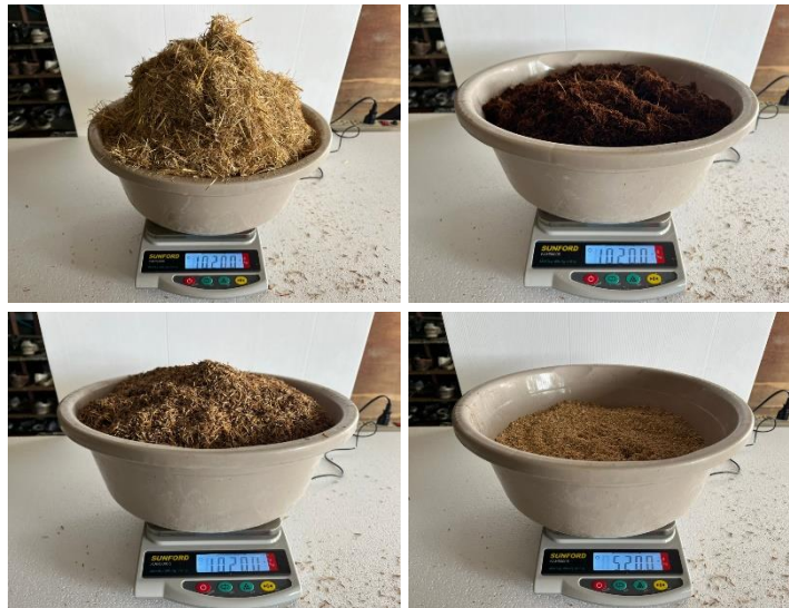
ภาพที่ 2 ชั่งน้ำหนักส่วนผสมของสูตรที่ 2
