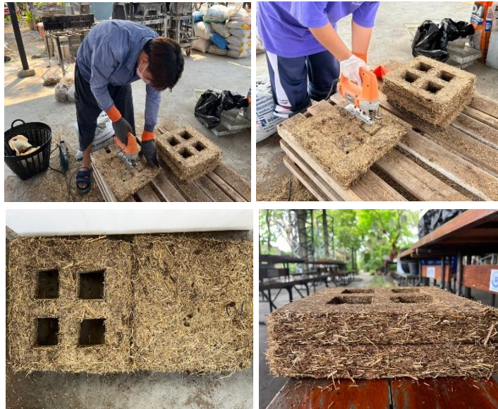
ภาพที่ 4 หลังจากที่ทำเสร็จนำมาตัดช่องสำหรับปลูกพรรณไม้จำนวนสูตรละ 4 แผ่น
