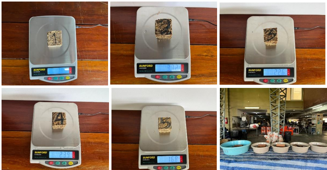
ภาพที่ 1 ชั่งน้ำหนักแต่ละสูตรก่อนแช่น้ำ
