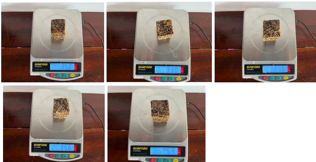
ภาพที่ 2 ชั่งน้ำหนักแต่ละสูตรหลังแช่น้ำ และจดบันทึกค่าการดูดซึมน้ำ
