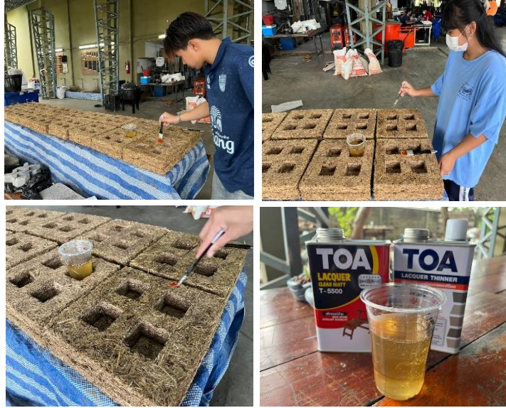
ภาพที่ 7 ทาแลคเกอร์เพื่อให้ผิวเรียบ ป้องกันน้ำ และความชื้น
