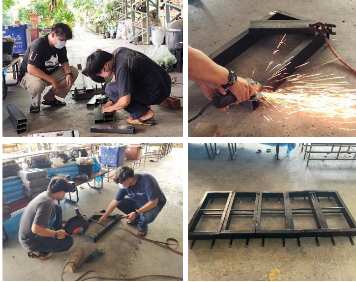
ภาพที่ 1 การทำกรอบสำหรับติดตั้งแผ่นปลุกพืช
