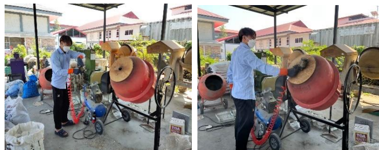
ภาพที่ 7 ระหว่างคลุกเคล้า จะทำการฉีดกาวไฮโซไซยาเนตเข้าไปด้วย
