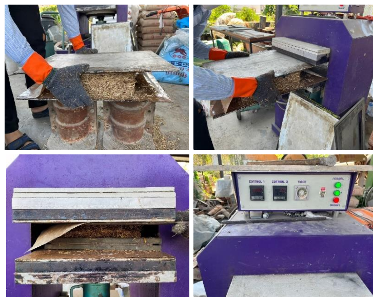
ภาพที่ 2 นำเข้าเครื่องอัดร้อน 7 นาที อุณหภูมิอยู่ที่ 150 องศาเซลเซียส
