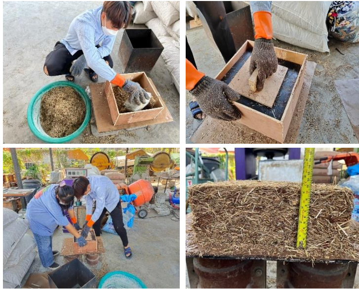
ภาพที่ 1 นำส่วนผสมที่ชั่งมาใส่ในบล็อกเพื่อที่จะทำการกดอัดให้ขึ้นรูป และนำเข้าเครื่องอัดร้อน ก่อนนำเข้าเครื่องอัดร้อนแผ่นปลูกพืชมีขนาด 10 เซนติเมตร
