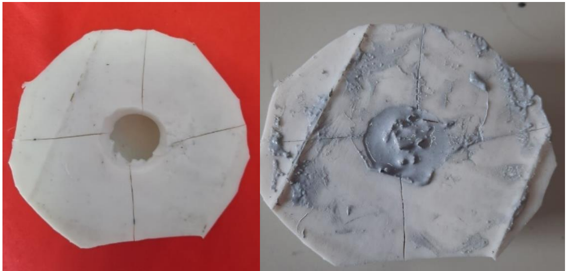
ภาพที่ 3.5 เทส่วนผสมลงไปในแม่พิมพ์ยางรอทิ้งไว้ให้แห้ง 1-2 คืน
