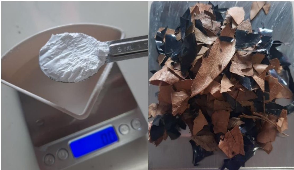
ภาพที่ 3.4 ขั้นตอนการผสมปูนกาวซีเมนต์เข้ากับเศษกิ่งไม้ใบไม้แห้งและเศษถุงปลูกปนละเอียด
