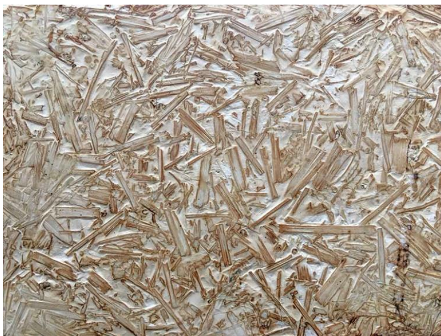
ภาพที่ 2.6 แผ่นคอมโพสิตทำจากใยเห็ดราที่ย่อยสลายได้ทางชีวภาพ 100 เปอร์เซ็นต์
