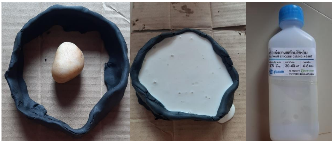
ภาพที่ 3.2 การทำแม่พิมพ์ยางซิลิโคนโดยใส่สารเร่งทำให้ยางซิลิโคนแข็งตัวไว
