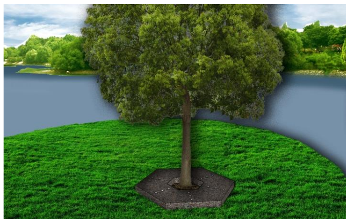
ภาพที่ 3.2 มุมมองการวางกรอบตะแกรงรอบโคนต้นไม้
