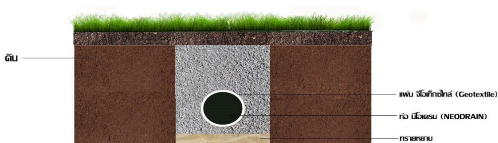
ภาพที่ 3.1 รูปแบบที่ 1 การใช้ท่อนีโอเดรนพันด้วยผ้าจีโอเทคไทล์
