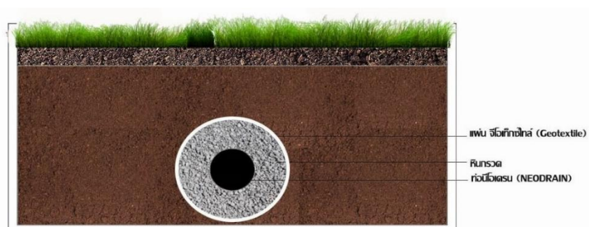
ภาพที่ 3.2 รูปแบบที่ 2 การใช้ท่อนีโอเตรนและหินกรวดพันด้วยผ้าจีโอเทคไทล์
