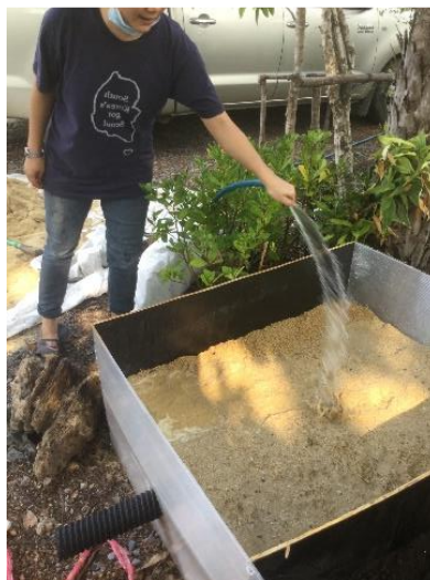
ภาพที่ 3.14 ปรับพื้นที่ให้เรียบพร้อมกับอัดแน่น รูปแบบที่ 2
