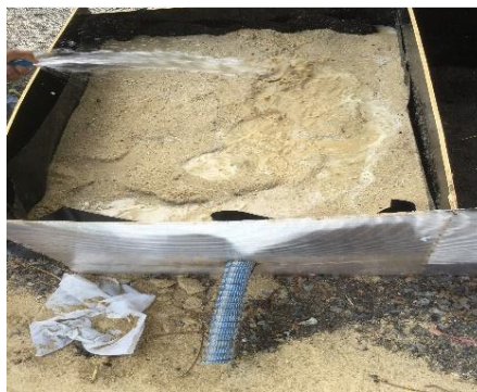
ภาพที่ 3.20 ปรับพื้นที่ที่เตรียมไว้ทำการทดลองให้เรียบพร้อมกั้นและปรับหน้าด้วยทราย
