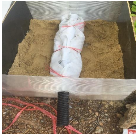
ภาพที่ 3.13 ม้วนผ้าจีโอเทคไทลปิดให้มิดหินกรวดและท่อ รูปแบบที่ 2
